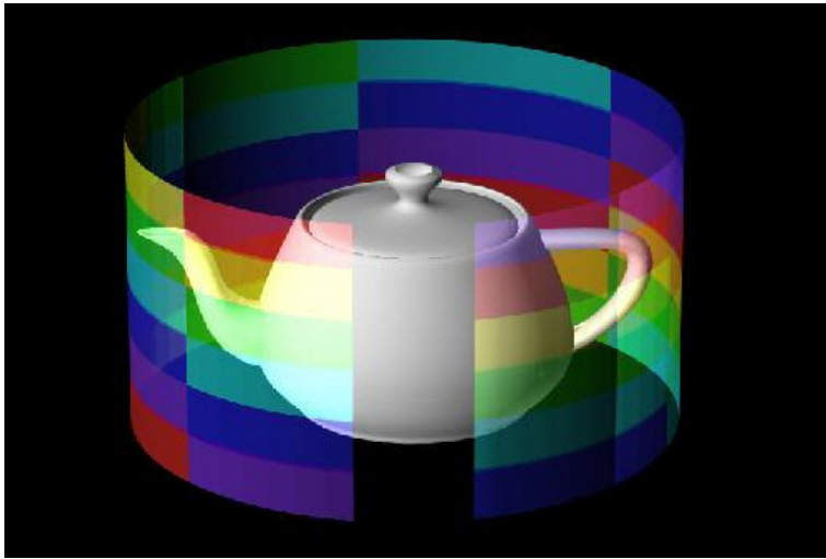
Figura 11.27 - Modello di proiezione cilindrica usata per i solidi che hanno una direzione di mappatura, come ad esempio un tronco di legno o una colonna. Nella mappatura cilindrica la faccia di sezione ha una mappa diversa.
